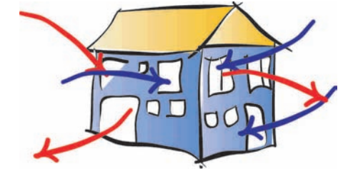
El exceso de ventanas trae problemas de pérdidas térmicas en invierno y ganancias en verano
