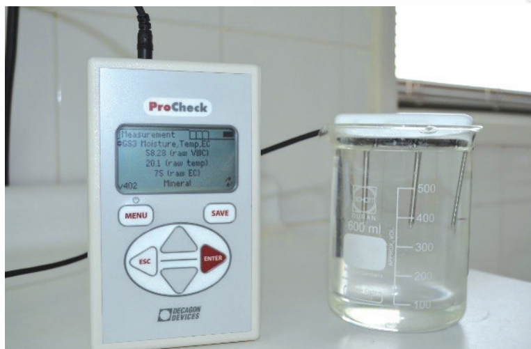
Figura 1 CONDUCTIVÍMETRO EQUIPO UTILIZADO PARA EL MONITOREO DE LA SALINIDAD DEL AGUA
