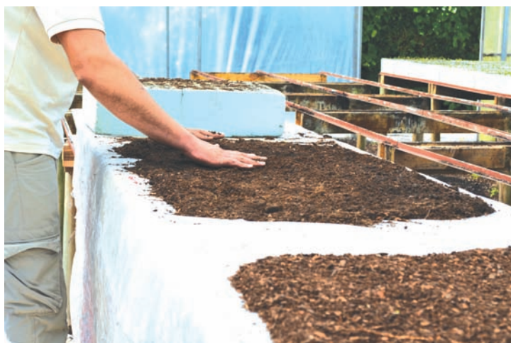
Figura 16 SECADO AL AIRE DEL SUSTRATO PARA ESTIMACIÓN DE LA HUMEDAD DE RETENCIÓN
