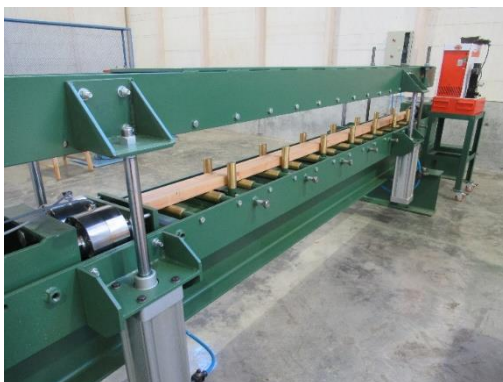
Figura N° 6 IMPLEMENTACIÓN DEL ENSAYO COMPRESIÓN PARALELA
