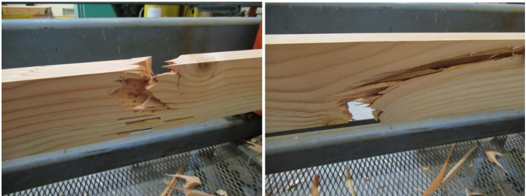
Figura N° 12 FALLA ENSAYO DE TRACCIÓN
