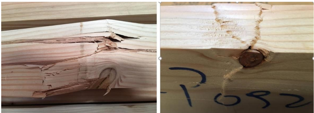
Figura N° 13 FALLA ENSAYO DE COMPRESIÓN PARALELA
