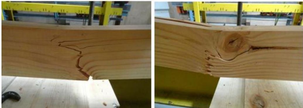
Figura N° 11 FALLA ENSAYO DE FLEXIÓN
