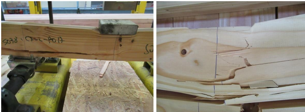
Figura N° 14 FALLA ENSAYO DE CIZALLE PARALELO
