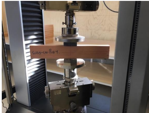
Figura N° 10 IMPLEMENTACIÓN DEL ENSAYO COMPRESIÓN NORMAL
