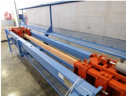
Figura N° 4 IMPLEMENTACIÓN DEL ENSAYO TRACCIÓN PARALELA
