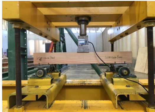
Figura N° 8 IMPLEMENTACIÓN DEL ENSAYO CIZALLE PARALELO
