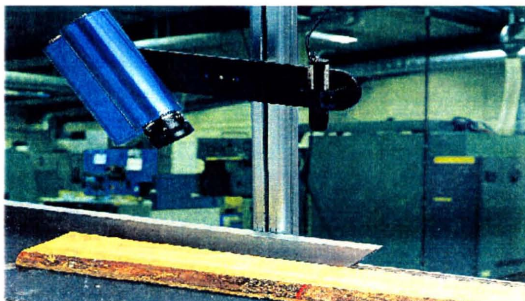
Figura 17 Triangulación láser aplicado en una pieza de madera.
