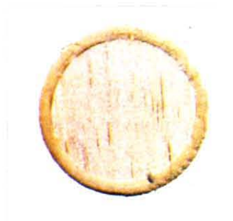
Figura 3: Probeta de pino sin lijar, producto "B" (cara). Dinamómetro 2,5 (N/mm 2 )
