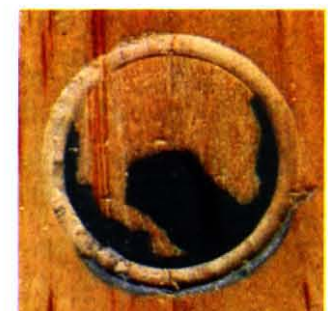
Figura 5: Probeta de pino sin lijar, producto "C" (cara). Dinamómetro 3,5 (N/mm 2 ).
