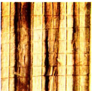
Figura 8: Probeta de pino sin lijar, producto "C" (canto). Adherencia cinta Grado 5
