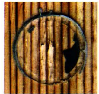
Figura 9: Probeta de pino sin lijar, producto "C" (canto). Dinamómetro 3,0 (N/mm 2 )
