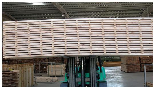
Madera empallada para secado
