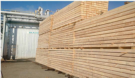
Carga de madera para ingreso a cámara
