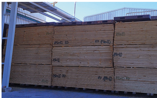
Contrapesos en cámara de secado
