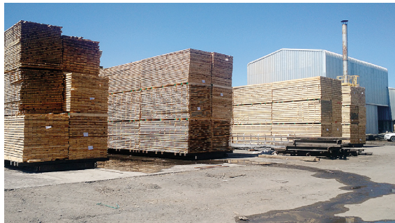
Cargas de madera para ingreso a cámara
