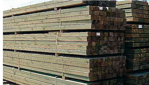
Madera impregnada con CCA
