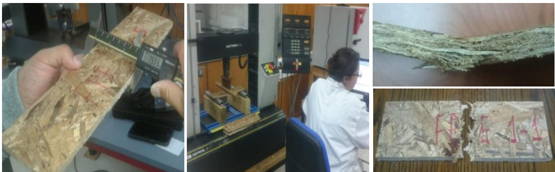
Figura N° 1 PROBETA PARA ENSAYO EN FLEXIÓN, ESQUEMA DEL ENSAYO Y FALLA DE LA PROBETA
