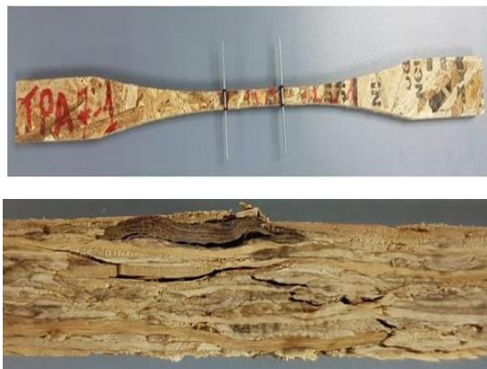
Figura N° 3 PROBETA ENSAYO DE TRACCIÓN, ESQUEMA DEL ENSAYO Y FALLA DE PROBETA EN TRACCIÓN
