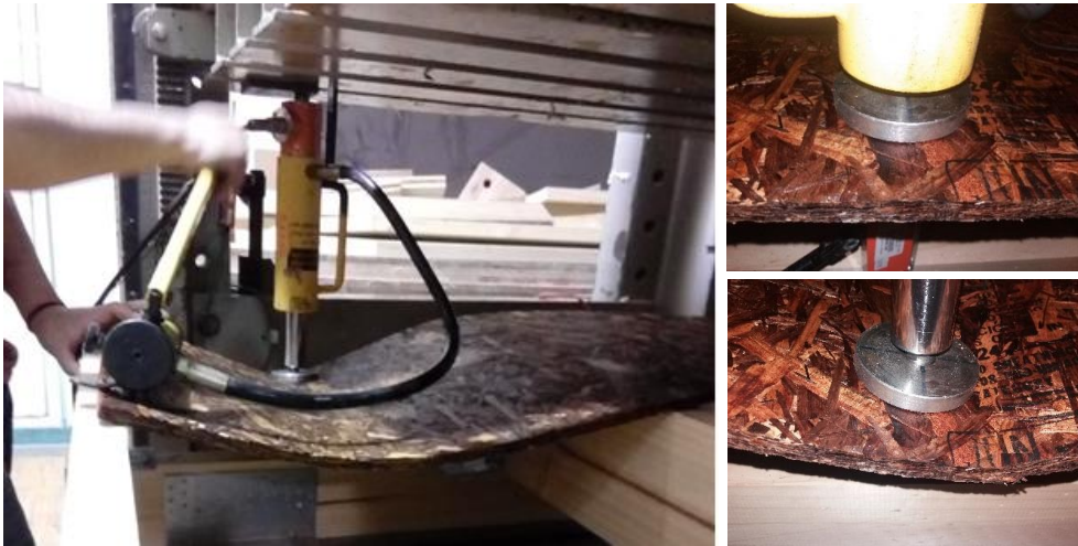
Figura N° 12 ESQUEMA GENERAL DEL ENSAYO Y PROBETA ANTES Y DESPUÉS DEL ENSAYO
