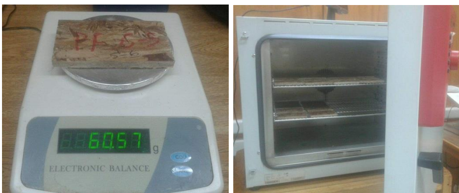
Figura N° 14 MEDICIÓN DE LA MASA Y SECADO EN ESTUFA DE LAS PROBETAS
