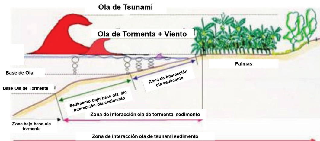
Figura 6. Costa del Tipo Arenosa donde la Presencia de un Bosque Permite Mitigar el Efecto de las Olas y el Viento
