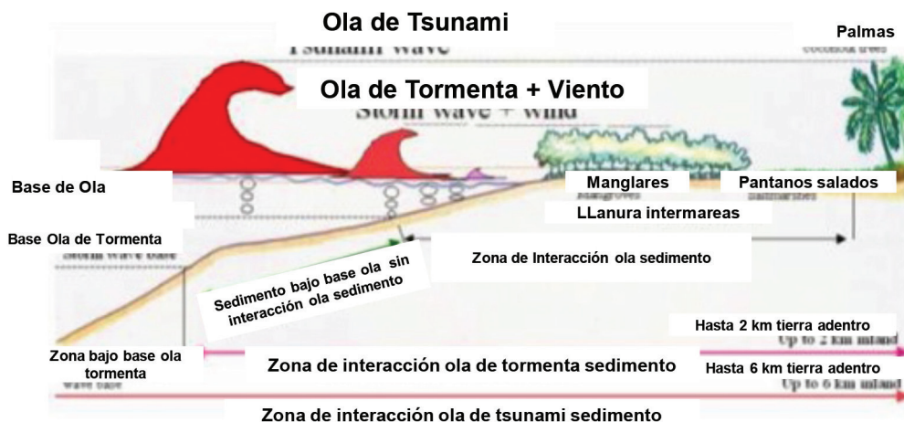
Figura 5. Perfil de un Costa del Tipo Fangosa Intermareal donde los Bosques y Árboles Costeros Pueden Servir como Barreras y Reducir la Altura de Ola
