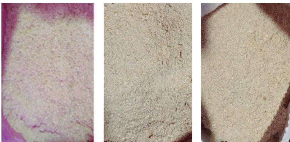
Figura 8. Astillado y tamizado de madera de Eucalyptus nitens y biomasa obtenida para elaboración de pellets.
