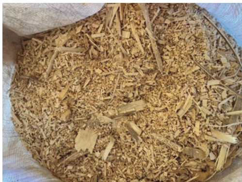
Figura 6. Astillado y tamizado de madera de Eucalyptus nitens y biomasa obtenida para elaboración de pellets.
