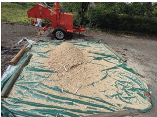
Figura 6. Astillado y tamizado de madera de Eucalyptus nitens y biomasa obtenida para elaboración de pellets.
