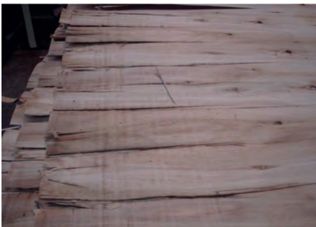
Figura N° 11 RAJADURAS EN LOS EXTREMOS DE LAS CHAPAS DE Eucalyptus nitens PRODUCTO DE LAS TENSIONES DE CRECIMIENTO
