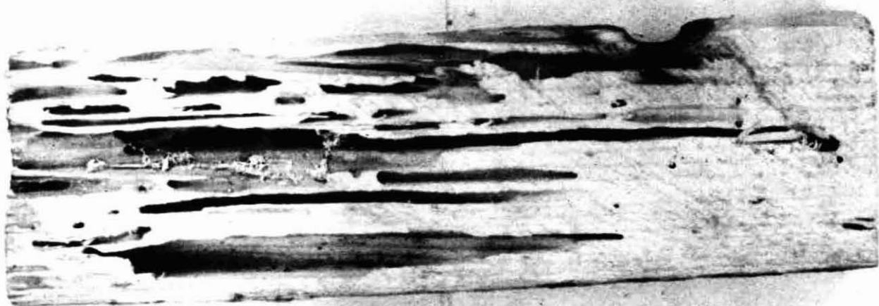
Destrucción ocasionada en madera de desarme de estanque por Cryptotermes brevis, Iquique. Madera: Pino oregón. (Pseudotsuga menziesii)
