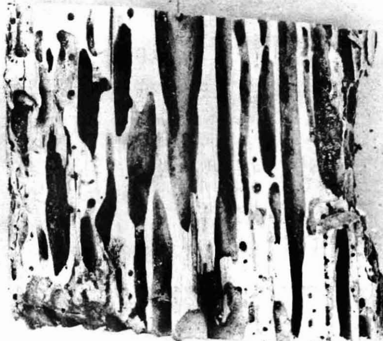
Destrucción ocasionada por Neotermes chilensis en pie derecho de casa, Caimanes Madera Alamo (Populus spp.)
