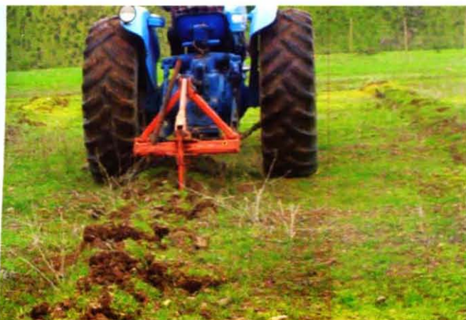
FIGURA 28. Detalle del tipo de subsolador con tractor utilizado en los ensayos de Huentelauquén y Tunga Norte
