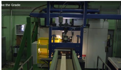
Figura N° 11 GRADESCAN LUCIDYNE EN OPERACIÓN EN ASERRADERO
