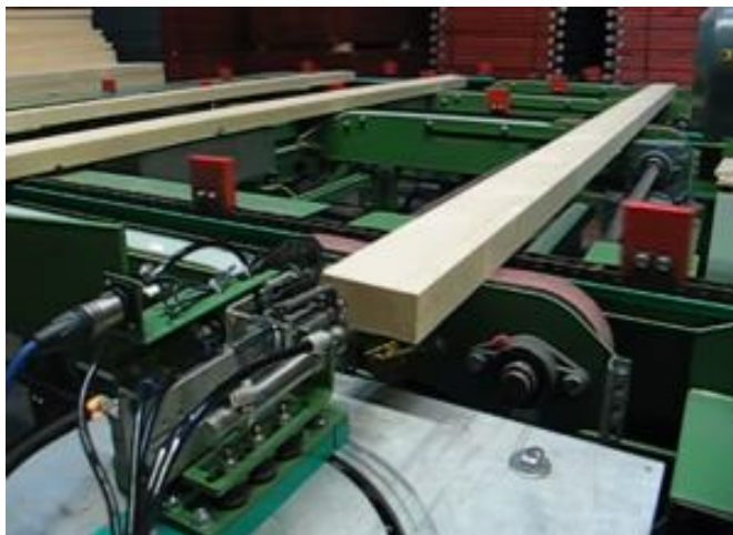
Figura N° 6 OPERACIÓN DE UN EQUIPO MTG BACH
