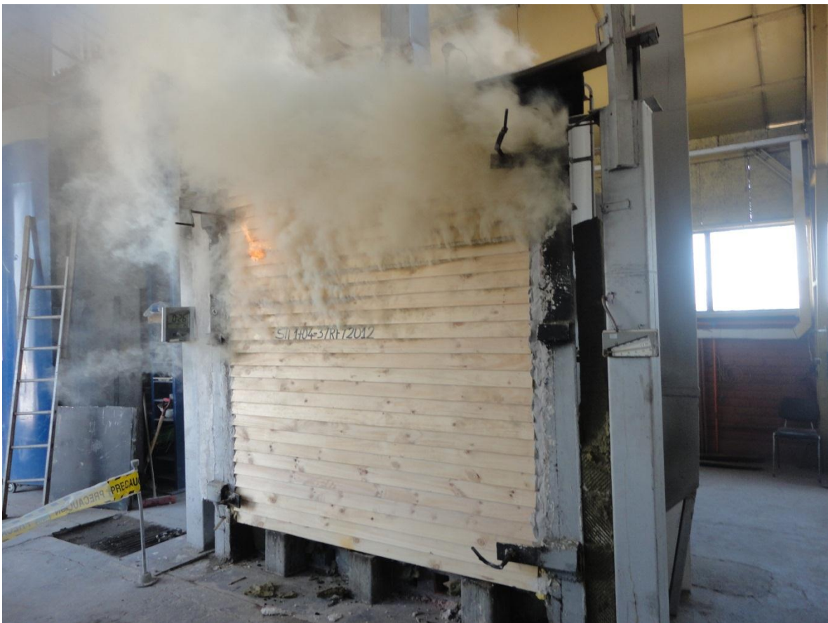
Figura 3.8: Muro M-2x4-11-MM durante el ensayo de resistencia al fuego.
