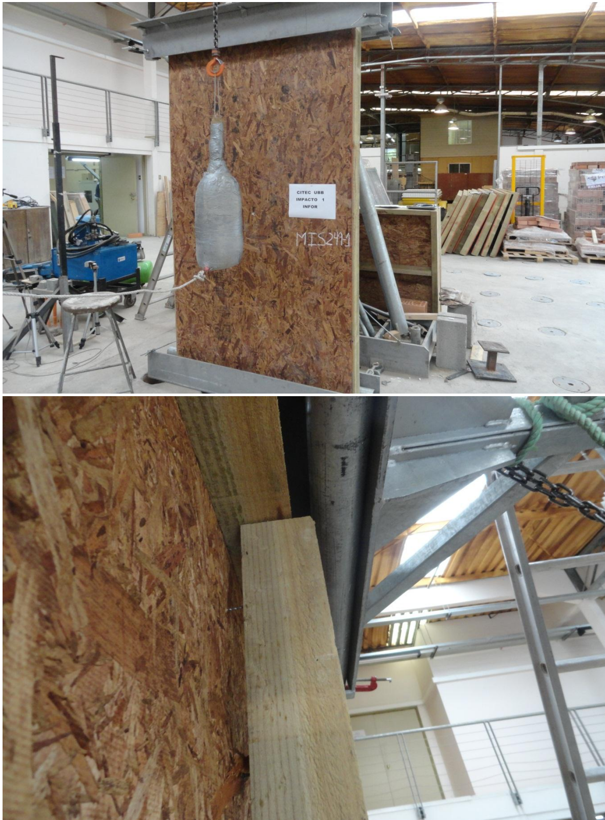
Figura 2.27: Modo de falla característico en ensayo de impacto en cara con placa arriostrante de muros con estructura de madera de pie derechos de 45x94 mm.
