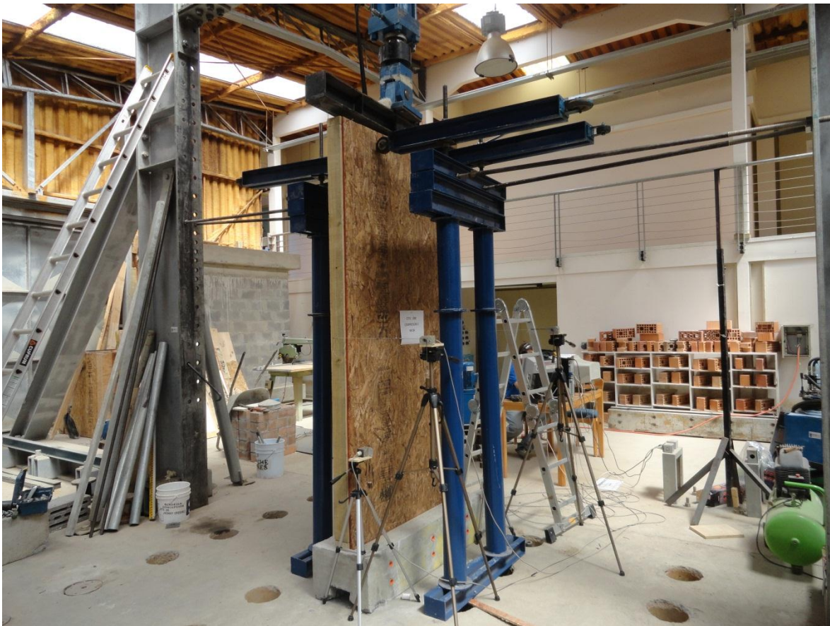
Figura 2.2: Implementación del ensayo de compresión en muros con estructura de madera.
