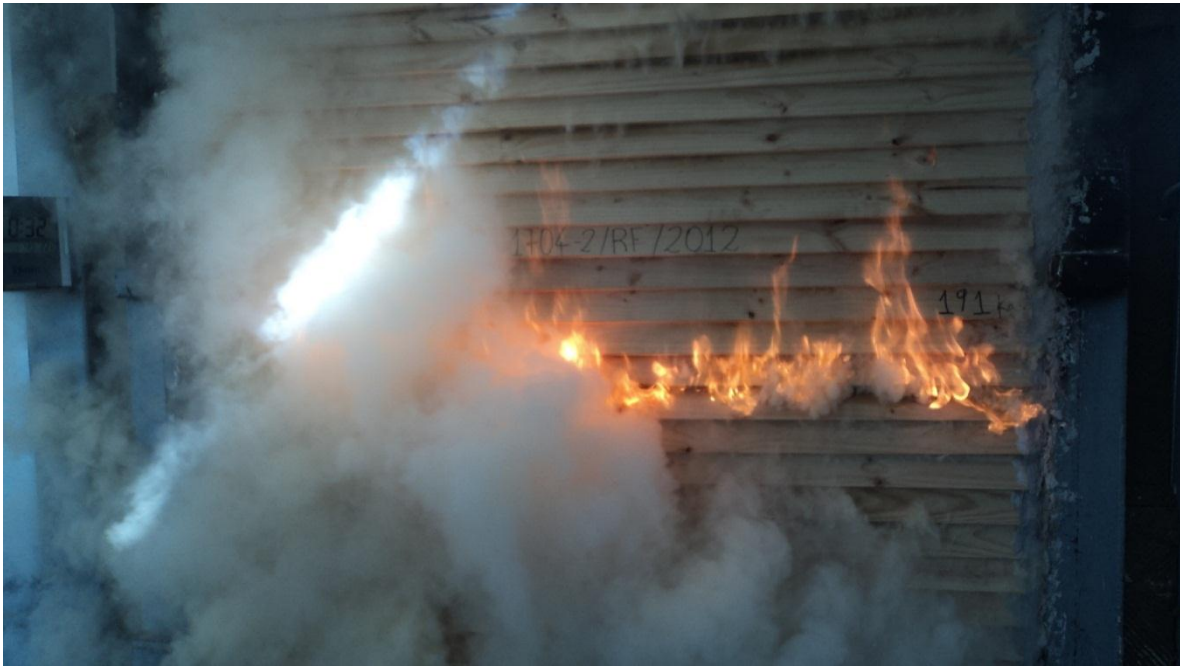
Figura 3.7: Muro M-2x3-11-MM durante el ensayo de resistencia al fuego.
