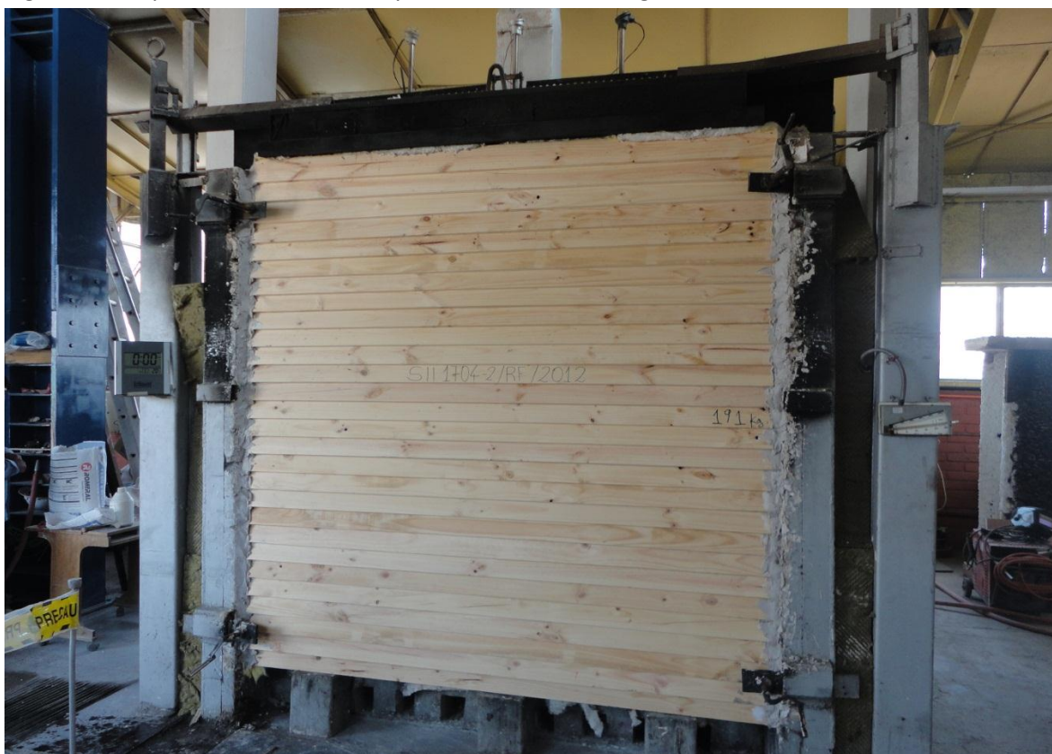
Figura 3.2: Implementación del ensayo de resistencia al fuego de muros con estructura de madera.
