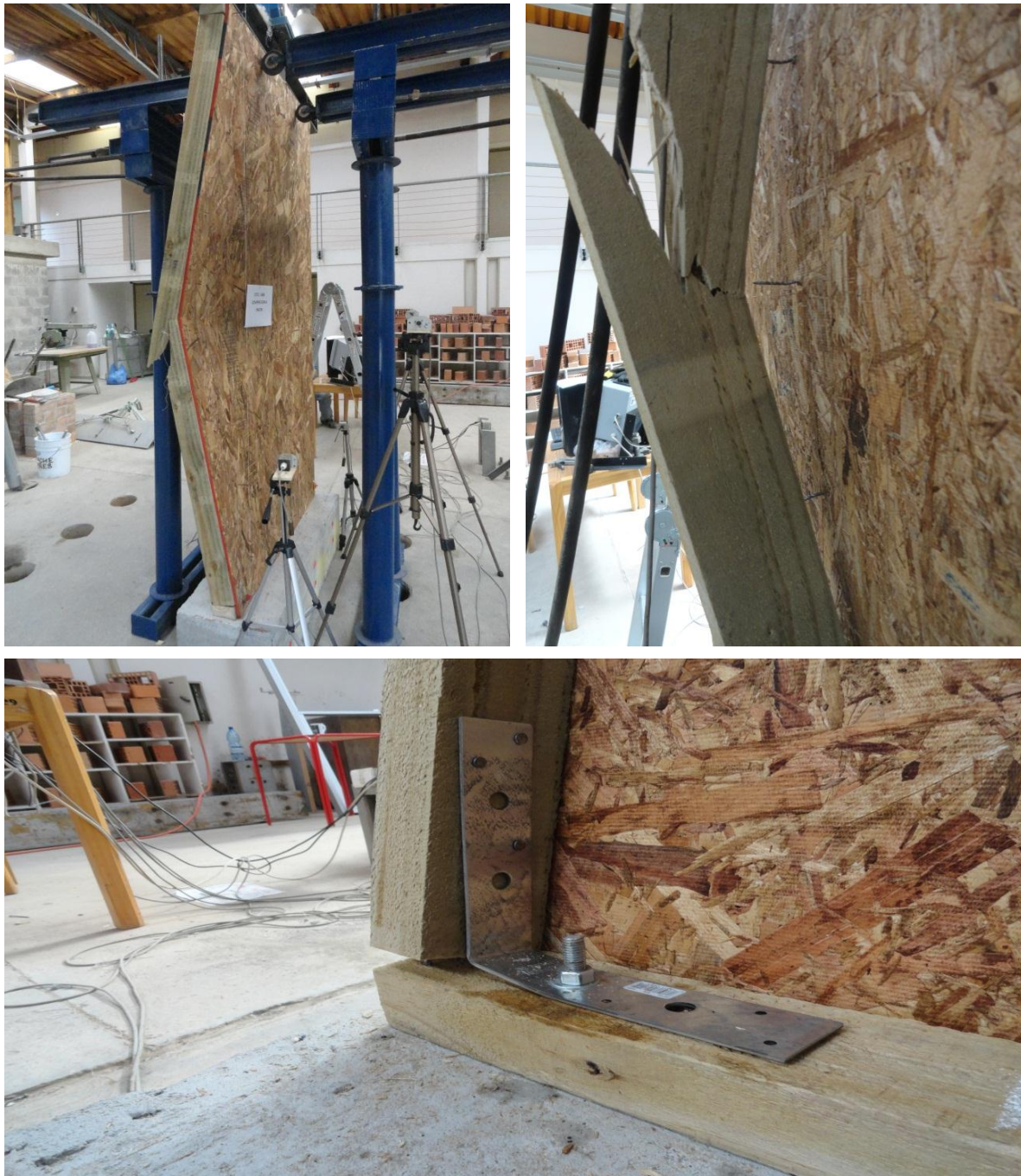
Figura 2.11: Modo de falla característico de ensayo de carga vertical en muros con estructura de madera.
