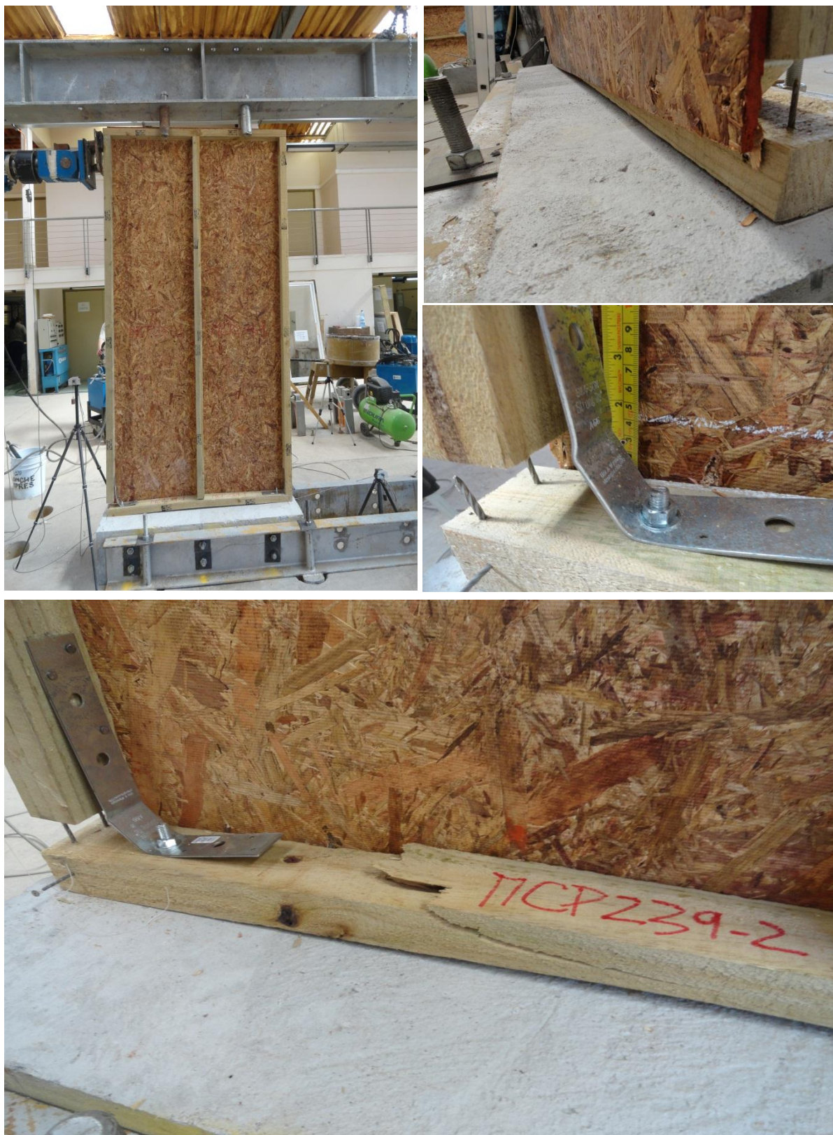
Figura 2.18: Modo de falla característico de ensayo de carga horizontal en muros con estructura de madera con sistema de anclaje perno y escuadra.
