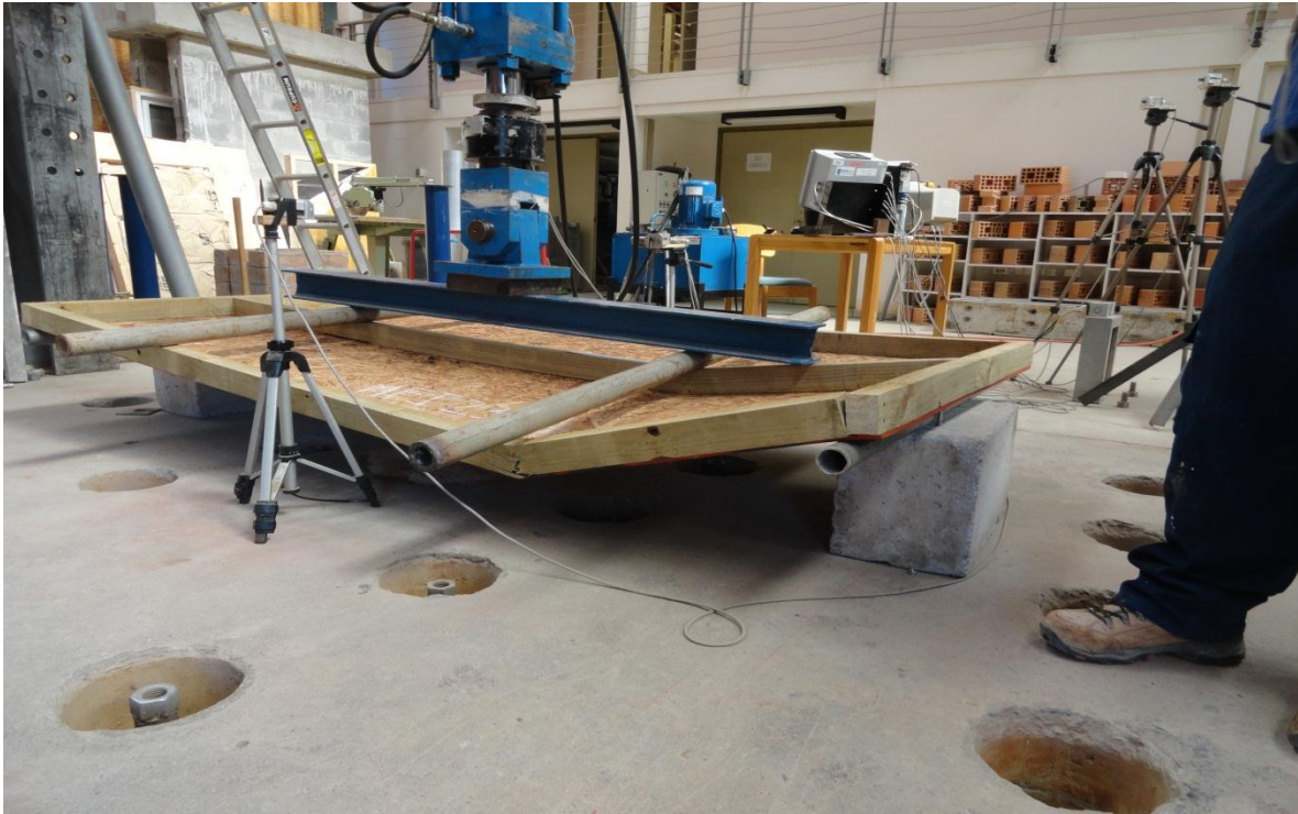
Figura 2.24: Modo de falla característico de ensayo de flexión en muros con estructura de madera con la carga aplicada en la cara sin placa arriostrante.
