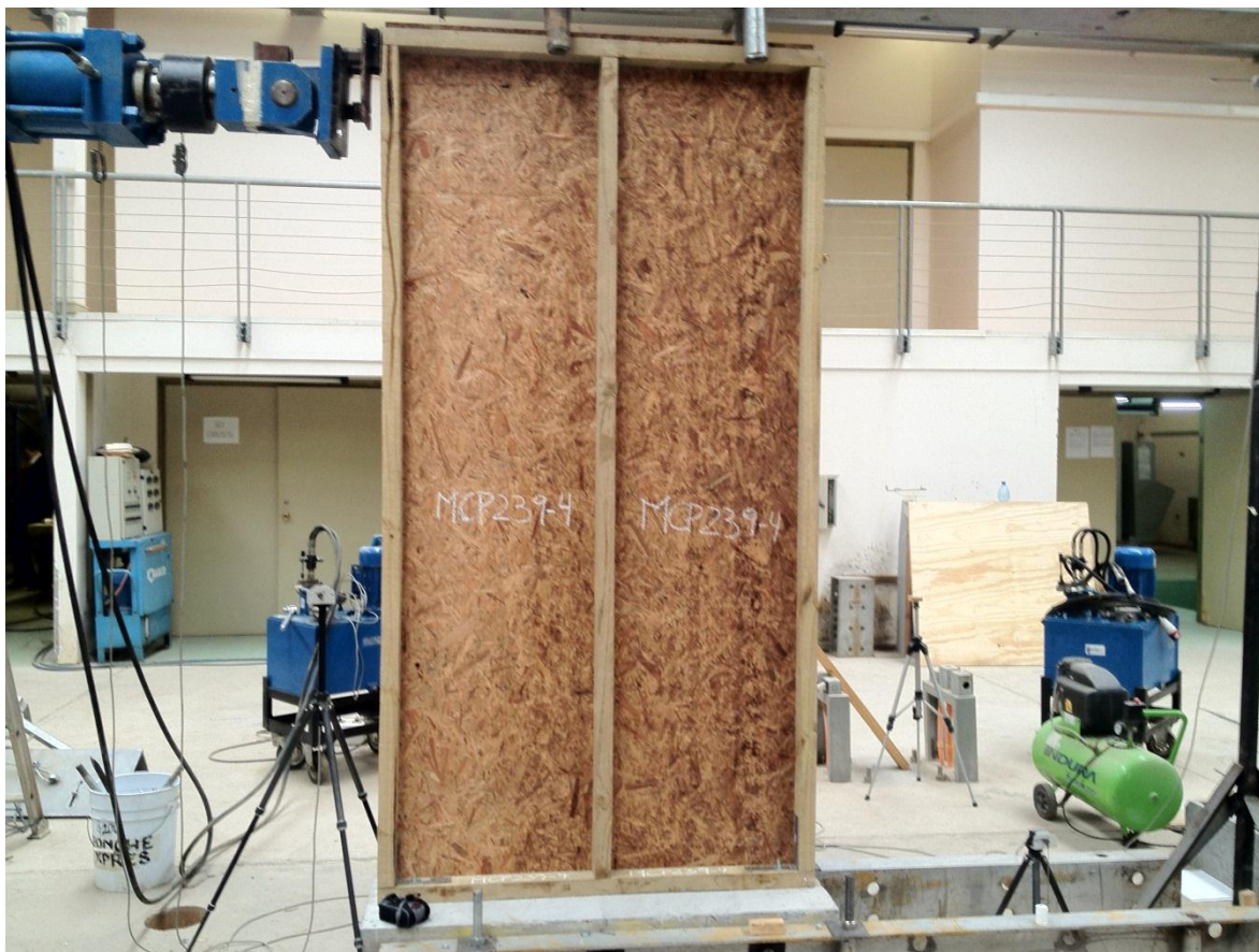
Figura 2.1: Tipología típica de muros con estructura de madera ensayados.
