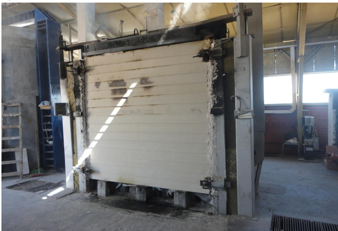
Figura 3.5: Muro M-2x3-9-YF durante el ensayo de resistencia al fuego.
