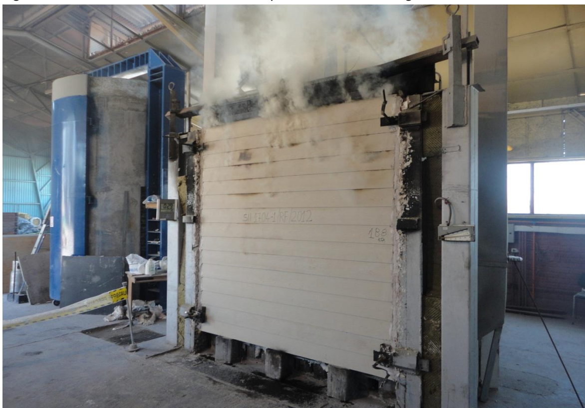
Figura 3.6: Muro M-2x4-9-YF durante el ensayo de resistencia al fuego.
