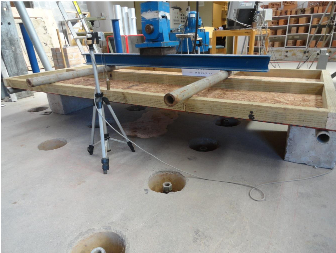
Figura 2.4: Implementación del ensayo de flexión en muros con estructura de madera.
