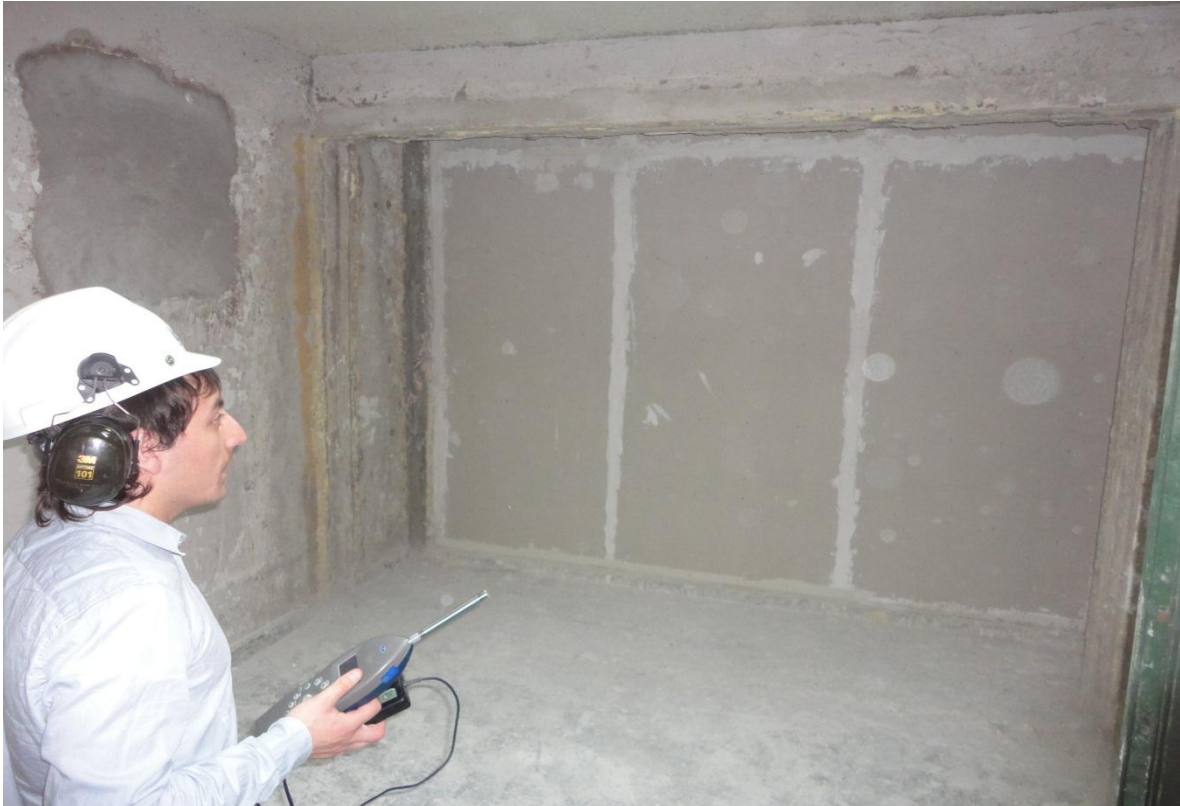
Figura 3.4: Implementación del ensayo de aislación acústica de muros con estructura de madera.
