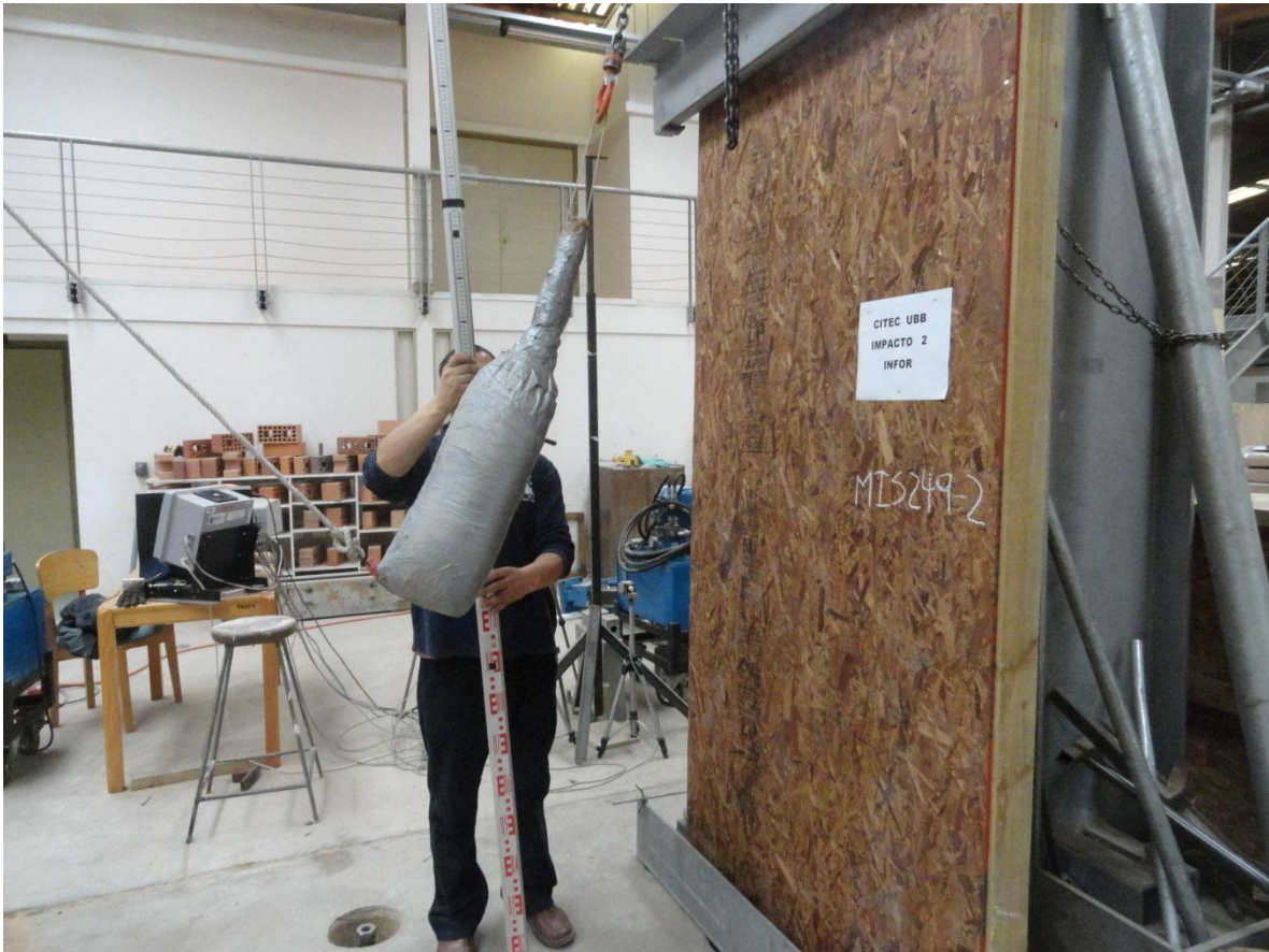
Figura 2.5: Implementación del ensayo de impacto en muros con estructura de madera.
