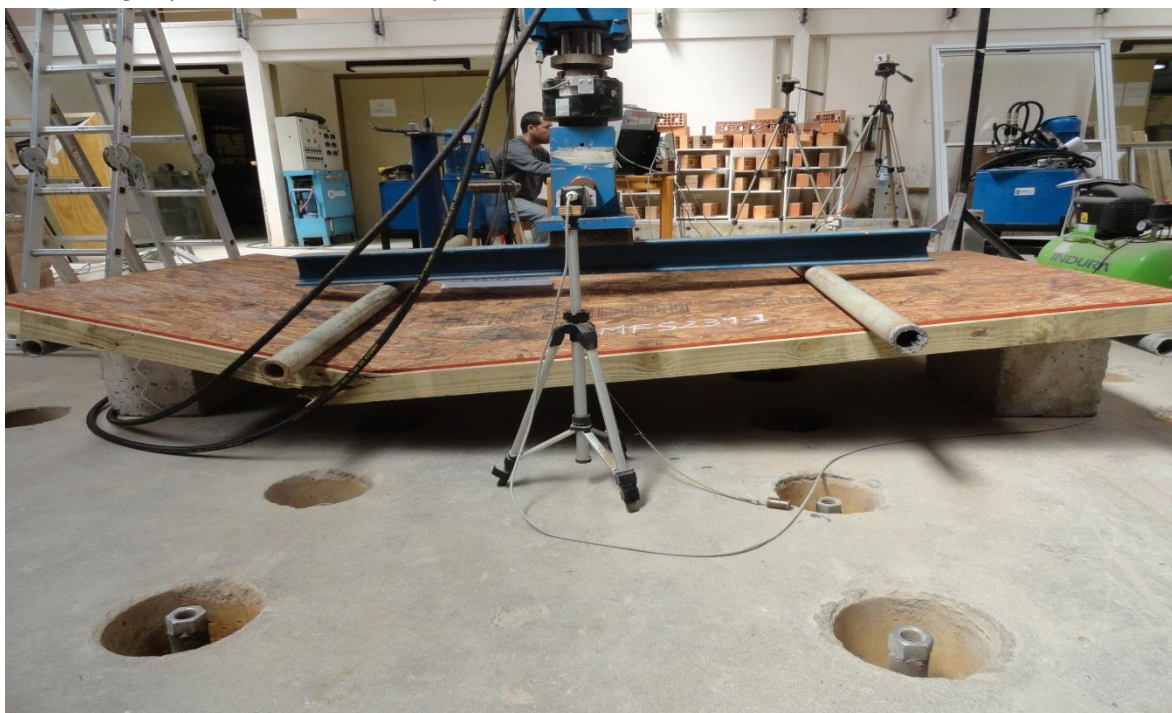
Figura 2.25: Modo de falla característico de ensayo de flexión en muros con estructura de madera con la carga aplicada en la cara con placa arriostrante.
