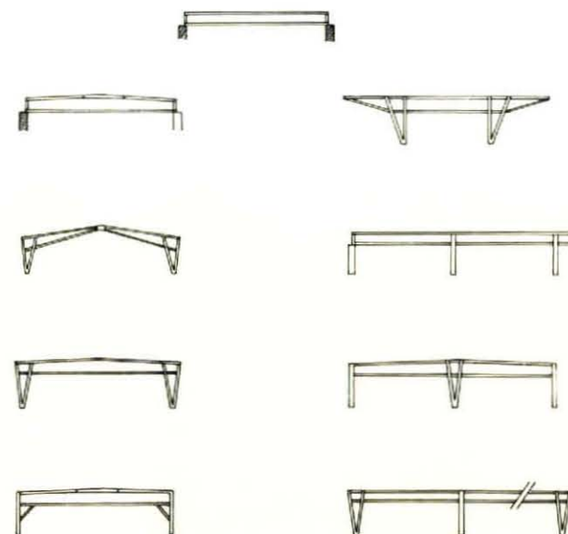
FORMAS ESTRUCTURALES CON SISTEMA HB
