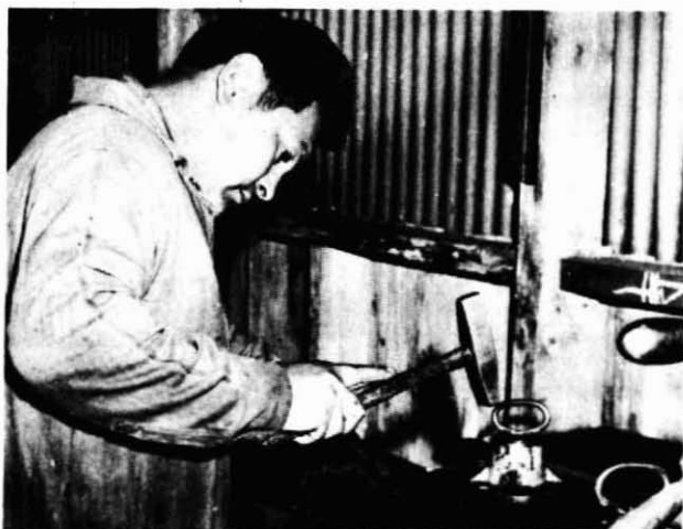
Martillando una sierra huincha para eliminar abolladuras longitudinales.
