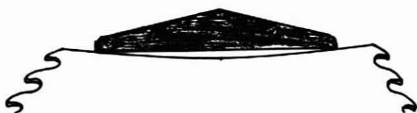
Fig. 25.- Controlando la tensión a una sierra huincha
