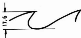
Fig. 32.- Determinación de la altura del diente
